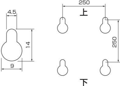
設置する壁面に左図の寸法に合わせてネジを仮止めします。
