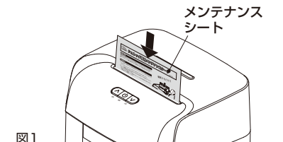
図1 シートに表記されている矢印の向きに従って、1枚投入してください。
