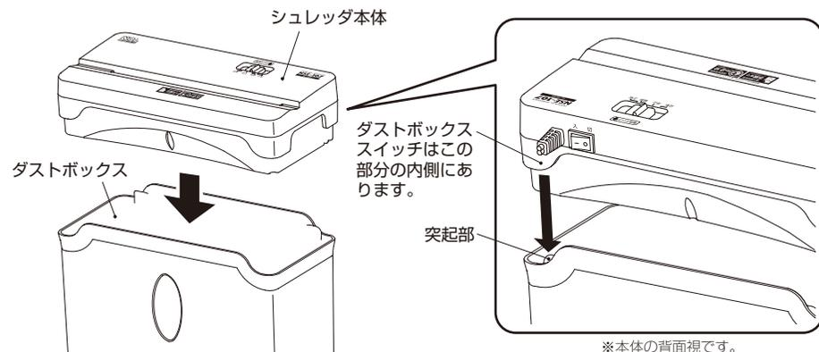
本体の背面に付いているダストボックススイッチがきちんと作動するように、ダストボックスの突起部が上図のようにセットされているか確認してください。
