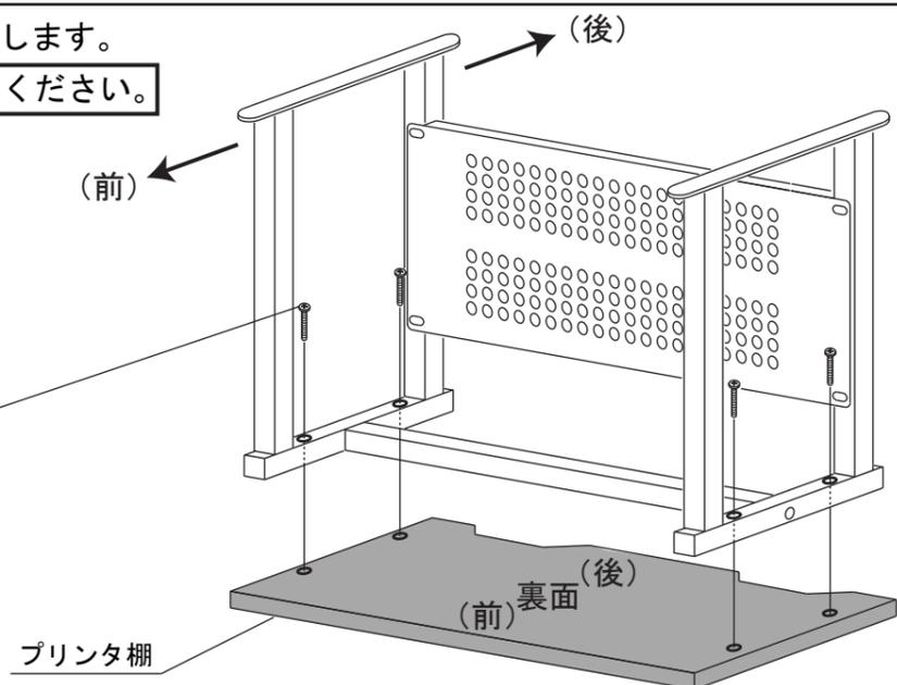
1) (仮締め) した全ての ボルト を締め付けてください。
